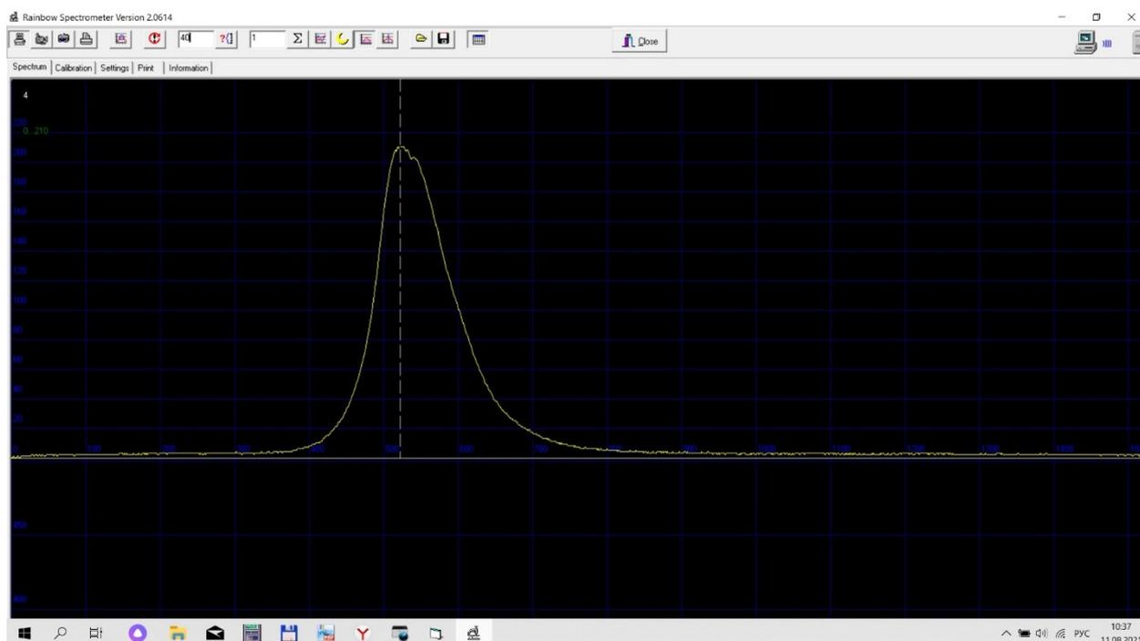
Здесь отображен спектр зелёного светодиода – длина волны 565 нм. График выведен с утопленной кнопкой – позиция тринадцать, которая включает автоматическое вычитание темновых токов, и связанных с ними шумов.
